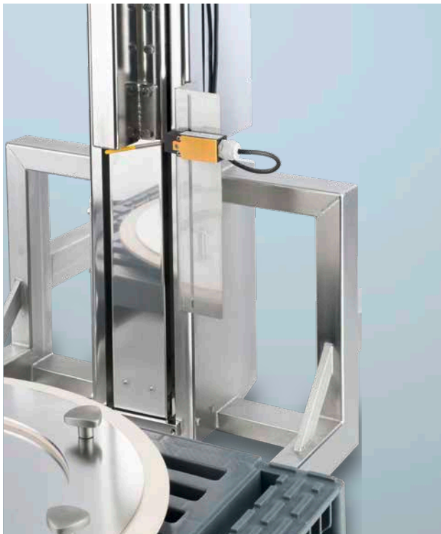
Prozessgerät mit Endlagenschalter.
