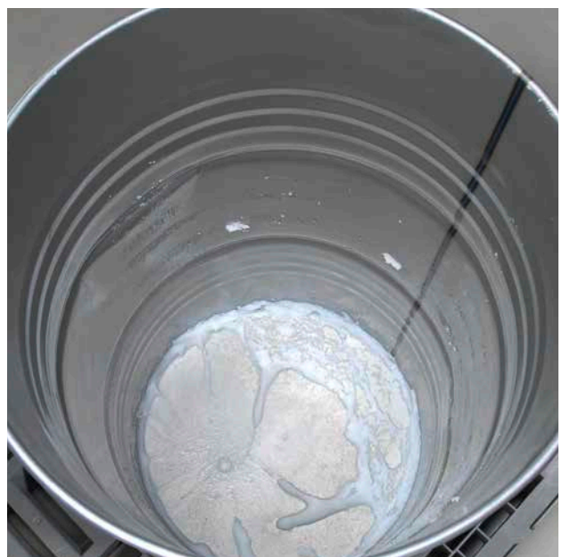
VISCOFLUX mobile S erreicht Restmengen bis unter 1 %, auch bei Fässern mit den üblichen Transportdellen.
