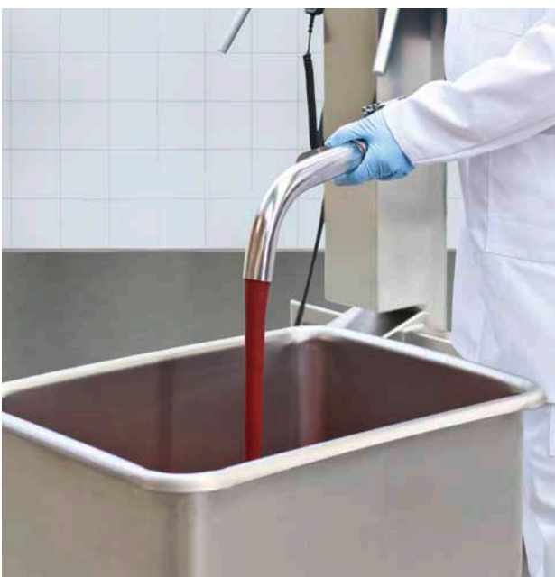
Lebensmittelgrundstoffe wie zum Beispiel Gemüse- und Fruchtkonzentrate lassen sich schonend und scherarm fördern.
