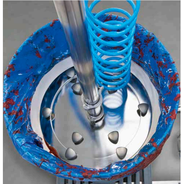
Hermetische Abdichtung des Mediums – Verarbeitung im geschlossenen Prozess.
